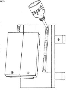
Der Kasten kann von außen mit einem umweltverträglichen Holzschutzmittel gestrichen werden. Innen muss er unbehandelt bleiben. Man kann aus einem Brett, das lang genug ist (siehe Zeichnung), die Bauteile selbst zusägen. Die Breite des Brettes
