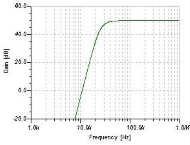
Der Vorverstärker ist zur Verstärkung des Ultraschallsignals oberhalb 15 kHz optimiert. Störgeräusche, die zur Übersteuerung der empfindlichen Vorstufe führen könnten, werden ausgeblendet.
